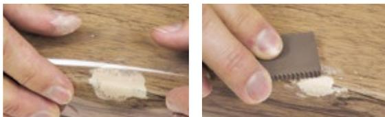
Extrem harter 2-K Tubenspachtel. Zur soliden Wiederherstellung eingedrückter Ecken und Kanten. Zum Wiedereinsetzen ausgebrochener Beschlagteile, Buchsen, Schrauben etc. Nach Härtung kann er zur Farbangleichung überlackiert werden. **Ergänzende Produkte für die Verarbeitung:** Roter Modellierspatel (S.21), Lack-Hobel (S.21), Transparente Sichtfolie (S.21), Fixierlack (S.16)
