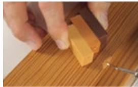
Das Hartwachs PLUS (Schmelzpunkt ca. 115°C) eignet sich für die Instandsetzung (Kratzer, Fehlbohrungen, Kantenschäden) von Dekor-, Kunststoff- und Echtholzoberflächen sowie folienkaschierten Oberflächen (Boden, Türen, Fenster). Lackier- bzw. versiegelbar. Farben untereinander mischbar. **Ergänzende Produkte:** Gasschmelzer (S.23), Füllstoff-Hobel (S.21), Pinsel-Fix Klarlack (S.14), Fixierlack C31 (S.16)
