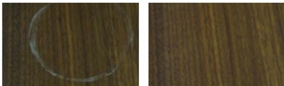
Schnell reagierender Lackanlöser, der für eine komplette Neuausbildung der obersten Lackschicht sorgt. Zur Beseitigung von Grauschleier, Wasser- und Alkoholflecken auf NC-Oberflächen. **Ergänzende Produkte für die Verarbeitung:** Trikot (S. 22)
