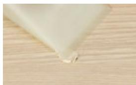
Weiches Wachs (Schmelzpunkt ca. 74°C), für kleine Kratzer und Löcher in Echtholz- und Dekoroberflächen im Innenbereich. Portionsweise mit der Spitze des Füllstoffhobels eindrücken und einfach abhobeln. Überlackierbar bzw. versiegelbar. **Ergänzende Produkte für die Verarbeitung:** Füllstoff-Hobel (S.21), Trikot (S. 22), Pinsel-Fix Klarlack (S.14), Fixierlack (S. 16)
