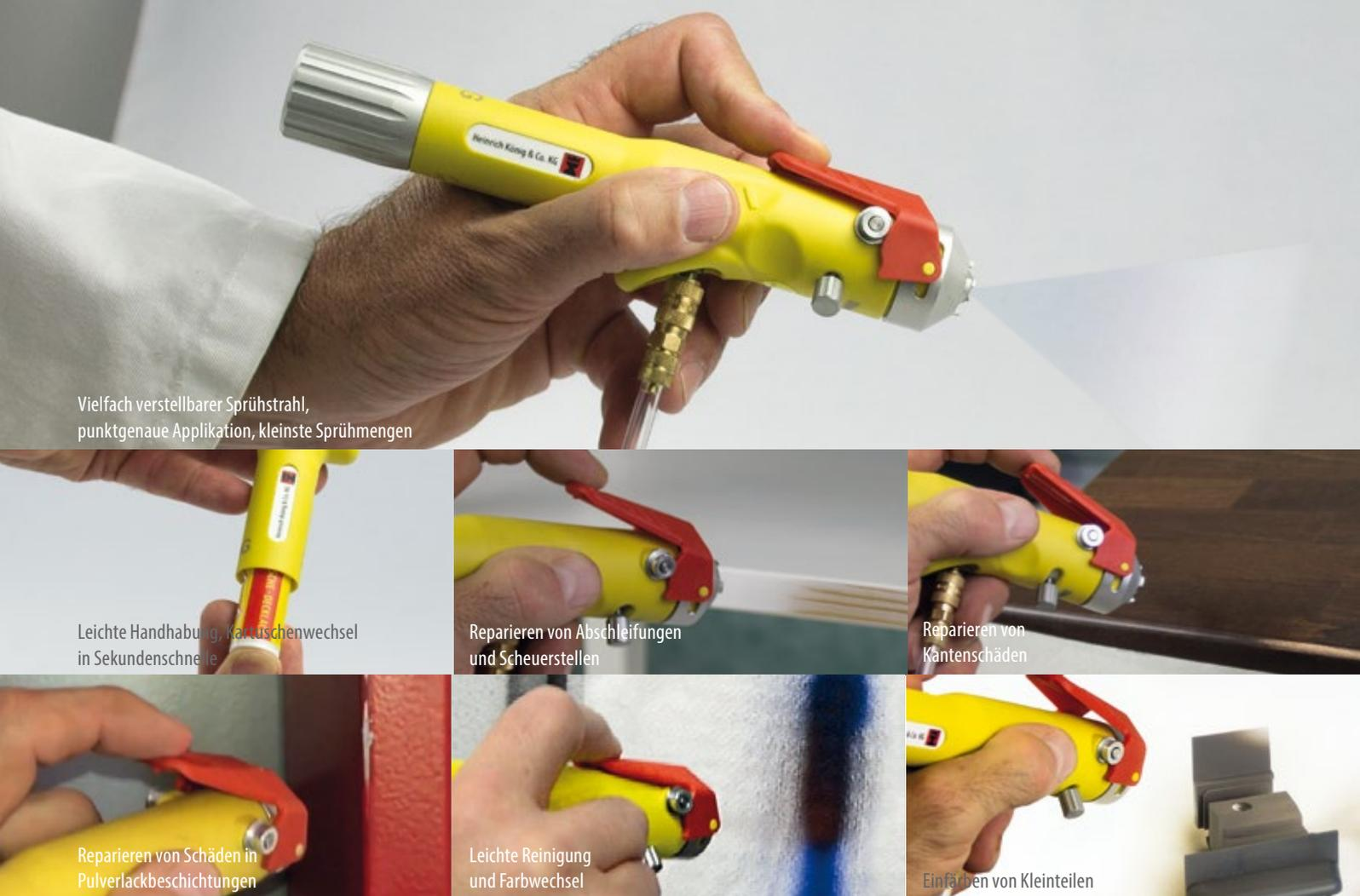
Vielfach verstellbarer Sprühstrahl, punktgenaue Applikation, kleinste Sprühmengen
