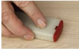
Hartes Wachs (Schmelzpunkt ca. 81°C) für tiefe Kratzer, Löcher und Kantenschäden in Echtholz- u. Dekoroberflächen sowie flexiblen Boden- u. Wandbelägen wie Vinyl, im Innenbereich. Schmelzen, einbringen, mit dem Füllstoff-Hobel plan arbeiten. Farben untereinander mischbar. Überlackierbar bzw. versiegelbar. **Ergänzende Produkte:** Gasschmelzer (S.23), Füllstoff-Hobel (S.21), Pinsel-Fix Klarlack (S.14), Fixierlack (S.16)
